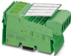
Inline, Module d'entrée analogique, Entrées analogiques: 8, 0 V ... 5 V, -5 V ... 5 V, 0 V ... 10 V, -10 V ... 10 V, 0 V ... 25 V, -25 V ... 25 V, 0 V ... 50 V, 0 mA ... 20 mA, 4 mA ... 20 mA, -20 mA ... 20 mA, 0 mA ... 40 mA, -40 mA ... 40 mA, connectique: 2 fils, vitesse de transmission dans le bus local: 500 kBit/s, indice de protection: IP20, y compris connecteurs mâles Inline et champs de repérage
