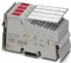
Inline, Bloc de jonction à relais, Sorties à relais: 4 (indépendant du potentiel), Contact inverseur, 24 V DC, 230 V AC, Pour la commutation de charges ohmiques, vitesse de transmission dans le bus local: 500 kBit/s, indice de protection: IP20, y compris connecteurs mâles Inline et champs de repérage
