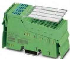
Inline, Module d'entrée numérique, Entrées TOR: 32, 24 V DC, connectique: 1 fil, vitesse de transmission dans le bus local: 500 kBit/s, indice de protection: IP20, y compris connecteurs mâles Inline et champs de repérage
